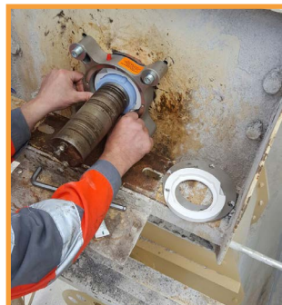
Segundo RotorCup y tapa de la carcasa instalados.
