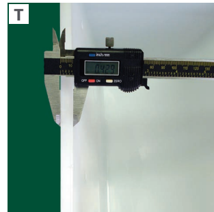
Para medir el espesor del cangilón utilizar un pie de rey.
